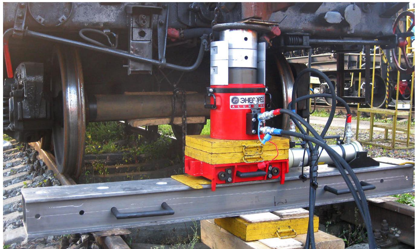
Предназначен для поперечного перемещения роликовой тележки по мостовой балке ЭНЕРПРЕД.
