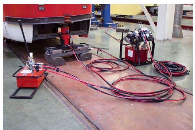
Предназначена для создания давления и подачи гидравлической жидкости в устройства системы ЭНЕРПРЕД для постановки легкого рельсового транспорта на рельсы.
