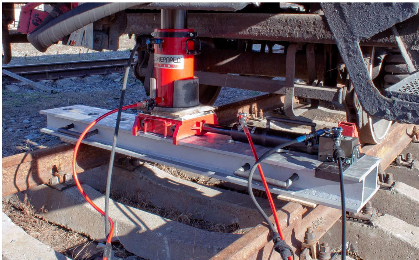
Предназначены для поперечного перемещения роликовой тележки по мостовой балке ЭНЕРПРЕД.
